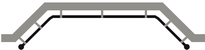
3 SIDED BAY WINDOW - BAIE VITRÉE À 3 CÔTÉS (2 single corner elbows - 2 rotules simple)
